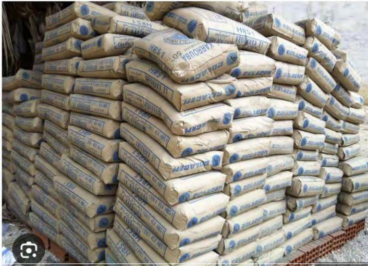
Todo el cemento gris que se use en la obra será Pórtland, de fabricación nacional de la mejor calidad y que llene los requisitos de la Ley de Construcciones, debiendo llegar a la obra en sus envases cerrados originales, y almacenado adecuadamente (no directamente sobre el piso ni recostado de las paredes del depósito) para mantenerlo libre de humedad. 7 de 7
